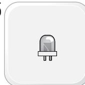
Индикатор выключен: модуль не получает сигнал активации дистанционного запуска.
