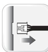
Отсоедините модуль от разъёмов. Питательный разъём отключите последним.
