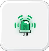
ПРИ ИСПОЛЬЗОВАНИИ ПРОШИВКИ SCA(ALL)-XX-IDL ПРИ ПОДАЧЕ ПИТАНИЯ НА МОДУЛЬ, ИНДИКАТОР МИГАЕТ **ОДНОКРАТНЫМИ** ВСПЫШКАМИ ЗЕЛЕНОГО ЦВЕТА, ЧТО ПОДТВЕРЖАЕТ, ЧТО МОДУЛЬ ЗАПРОГРАММИРОВАН ДЛЯ ЗАПУСКА ОТ ДОПОЛНИТЕЛЬНОЙ СИГНАЛИЗАЦИИ С УПРАВЛЕНИЕМ ПО ЦИФРОВОМУ ПРОТОКОЛУ **"2-WAY DATA"**
