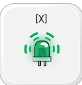
ДЛЯ ПЕРЕКЛЮЧЕНИЯ В РЕЖИМ УПРАВЛЕНИЯ **"ПО АНАЛОГУ" (HARDWIRED)**, КОРОТКИМ ОДНОКРАТНЫМ НАЖАТИЕМ КНОПКИ ПРОГРАММИРОВАНИЯ ПЕРЕКЛЮЧИТЕ МОДУЛЬ В ЭТОТ РЕЖИМ. ИНДИКАТОР БУДЕТ МИГАТЬ **ДВОЙНЫМИ** ВСПЫШКАМИ ЗЕЛЕНОГО ЦВЕТА. ОДНОКРАТНЫМИ НАЖАТИЯМИ МОЖНО ПЕРЕКЛЮЧАТЬ РЕЖИМЫ IDL->HWD->IDL ДО ПОДТВЕРЖДЕНИЯ РЕЖИМА.
