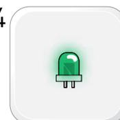
Индикатор горит зеленым затем гаснет: модуль в процессе завершения сброса данных.
