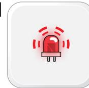
Индикатор мигает красным: модуль неправильно подсоединен или запрограммирован либо не «видит» активности в шине данных до включения зажигания (справедливо не для всех прошивок).
