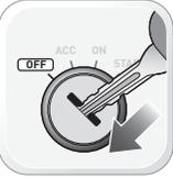
ВСТАВЬТЕ КЛЮЧ В ЗАМОК ЗАЖИГАНИЯ
