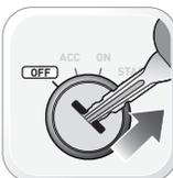
ВЫТАЩИТЕ КЛЮЧ ИЗ ЗАМКА ЗАЖИГАНИЯ, ИНДИКАТОР ПОГАСНЕТ
