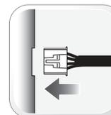
СНАЧАЛА ПОДКЛЮЧИТЕ 4-PIN РАЗЪЕМ ПИТАНИЯ, ЗАТЕМ ОСТАЛЬНЫЕ РАЗЪЕМЫ К МОДУЛЮ
