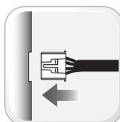
После завершения 2-го этапа программирования отключите модуль от компьютера и подсоедините к разъёмам в автомобиле. Питающий разъём подключите первым.
