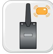
Светодиод антенного модуля однократным морганием будет подтверждать успешность записи каждого брелока.
