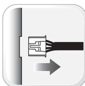
Отсоедините модуль от разъёмов. Питающий разъём отключите последним.
