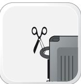
Разрежьте петлю выбора типа трансмиссии для автомобиля с АКПП.
