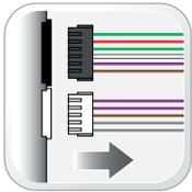
Отсоедините все разъемы от модуля, за исключением питающего разъёма M4.
