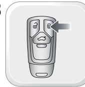
Нажмите три раза кнопку блокировки центрального замка на ключе автомобиля.
