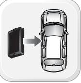
Подключите модуль к жгуту проводов в автомобиле. Питающий разъём подсоедините в первую очередь. **ВНИМАНИЕ!** Не нажимайте кнопку программирования.
