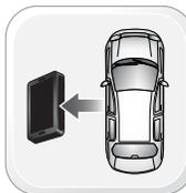
Отключите модуль от жгута проводов в автомобиле. Питающий разъем М4 отсоедините последним.
