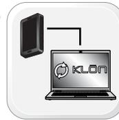
Подключите модуль к компьютеру для продолжения процедуры «KLON». «Кликните» по виртуальной кнопке «PROCEED» и дождитесь окончания процесса клонирования.
