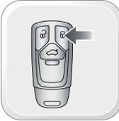
Нажмите три раза кнопку блокировки центрального замка на ключе автомобиля.
