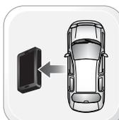
Отключите модуль от жгута проводов в автомобиле. Питающий разъём M4 отсоедините последним.
