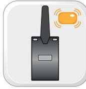
Светодиод антенного модуля однократным морганием будет подтверждать успешность записи каждого брелока.
