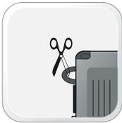
Разрежьте петлю выбора типа трансмиссии для автомобиля с АКПП.
