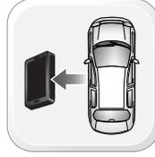
Отключите модуль от жгута проводов в автомобиле. Питающий разъем M4 отсоедините последним.
