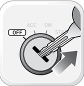
Извлеките ключ из замка зажигания.
